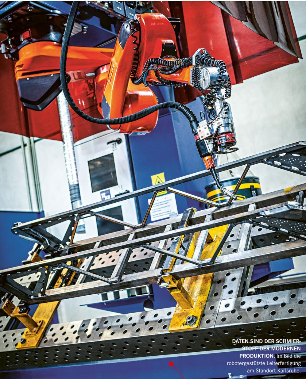
DATEN SIND DER SCHMIERSTOFF DER MODERNEN PRODUKTION. Im Bild die robotergestützte Leiterfertigung am Standort Karlsruhe.
