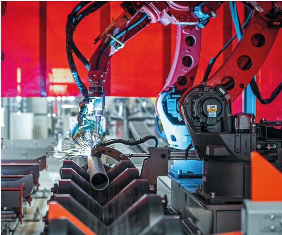
Roboterisierte Vorfertigung von Sprinklerrohren
