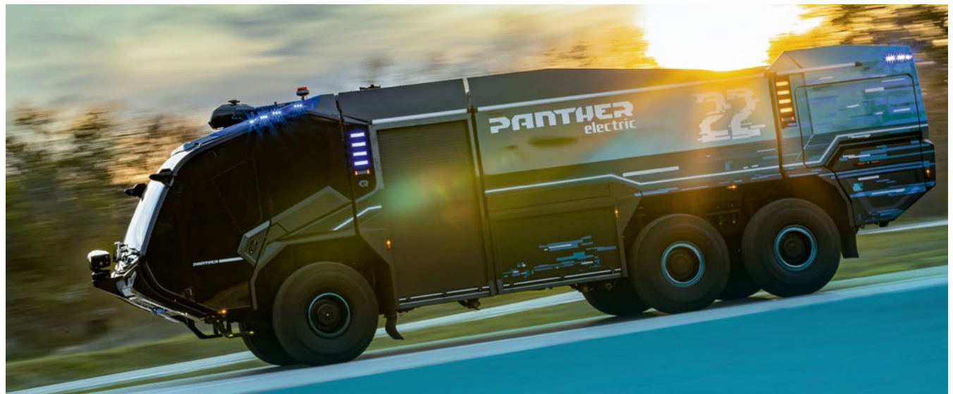
PANTHER electric: Flughafenlöschfahrzeug mit elektrischem Antriebsstrang.
