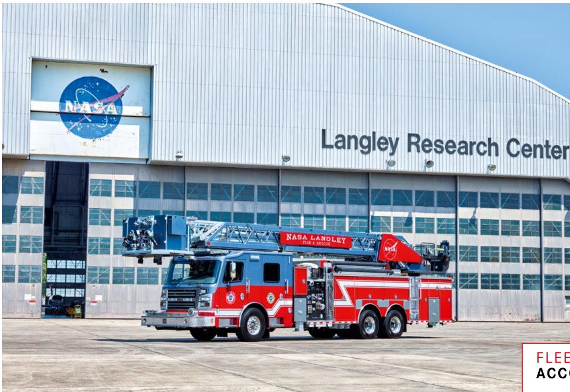
Cobra Hubrettungs­bühne mit Pumpe und Tank auf Commander- Chassis für das Langley Research Center der NASA in Virginia
