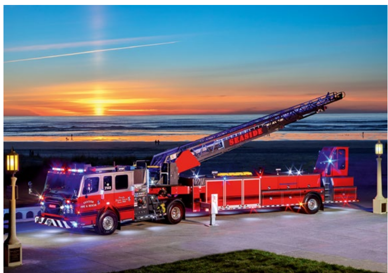
Tractor Drawn Aerial (Tiller Ladder) mit lenkbaren Hinterachse und 30,5 m Leitersatz für das Seaside Fire & Rescue Department in Oregon
