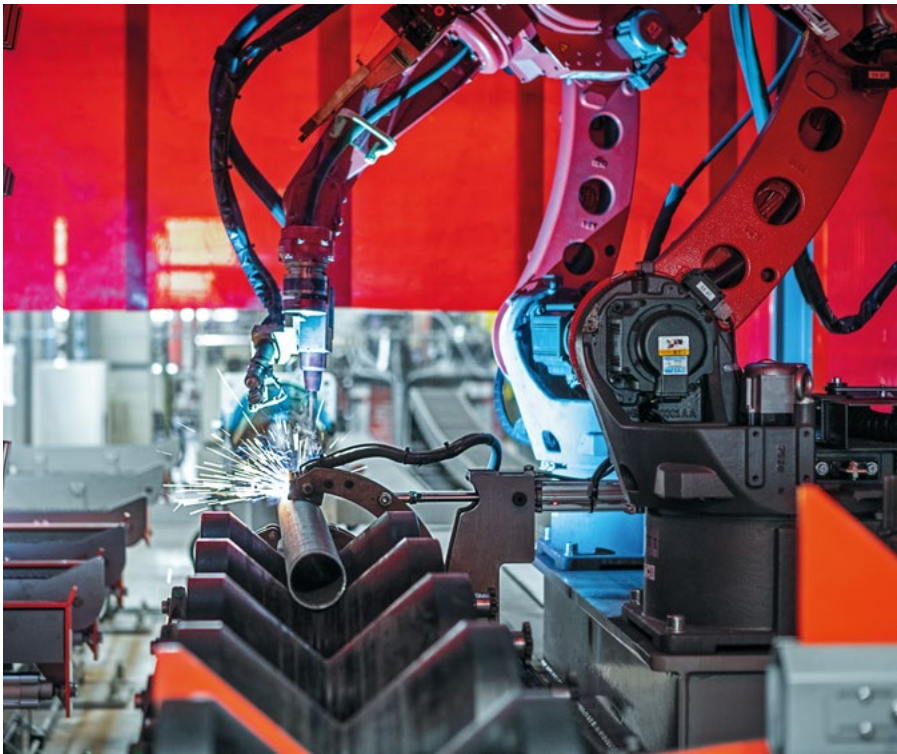
Roboterisierte Vorfertigung von Sprinklerrohren
